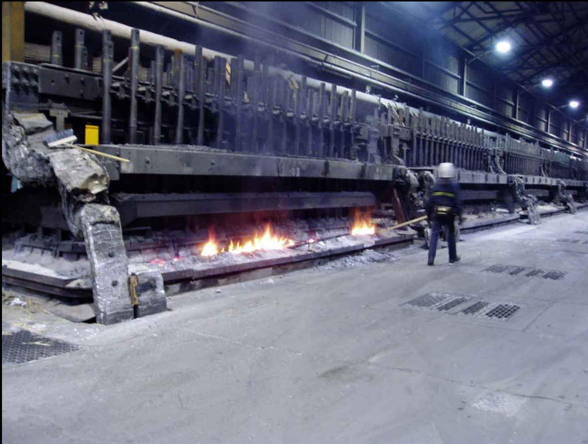
Vertical Stud Söderberg (VSS) Cells
